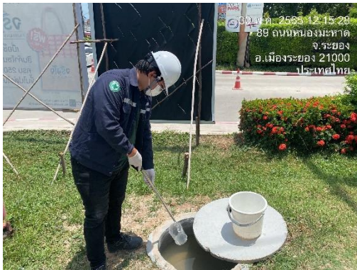
รูปที่ 22 การเก็บตัวอย่างคุณภาพน้ำทิ้งของโครงการ
