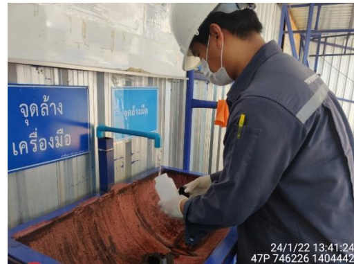
รูปที่ 23 การเก็บตัวอย่างคุณภาพน้ำใช้
